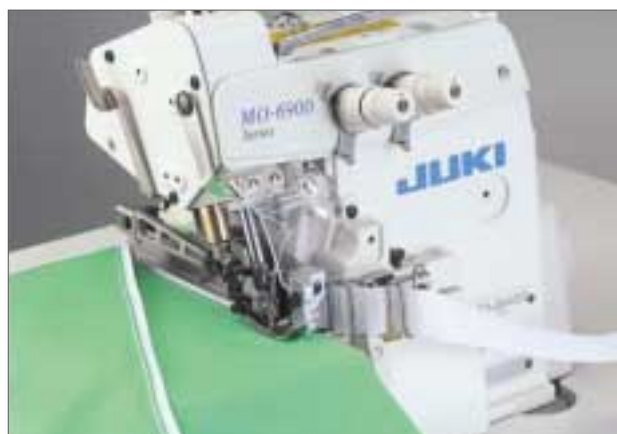
● テープ巻込み縫 MO-6945S-ED4-360/N077(N077: 四ツ巻きバインダー)
