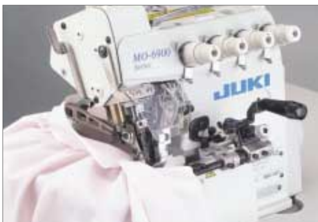
● ひだ取り MO-6914S-BE6-327/S162 (S162: ひだ取り装置)
