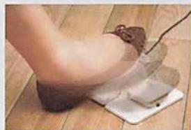
コントロールペダルと糸切りスイッチが足元で一体化。縫いに続けて自然な動作で糸切りができます。ペダルと糸切りスイッチの左右を入れ替えて使うこともできます。
