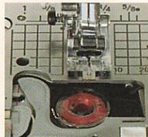
下糸のセットは、ガイドに沿って糸かけをするだけで完了します。下糸を引き出さずにぬい始められます。
