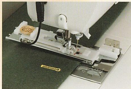
独自のセンサー方式で生地の状態や段差の影響を常に判断し、最適な送りを提供していきます。左右のぬい密度が揃った美しいボタンホールに仕上がります。
